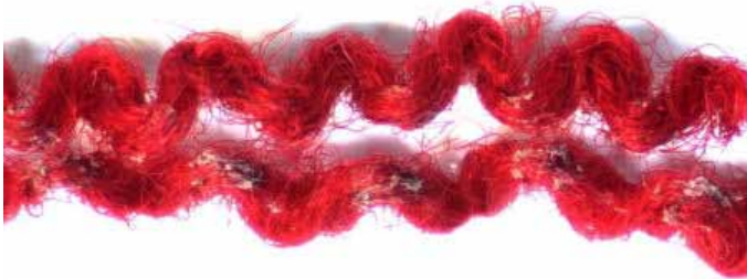
Tapijtgarens verwijderd uit tapijt na latexering bovenste garen uit onbehandeld tapijt - onderste garen uit tapijt met coronabehandeling
