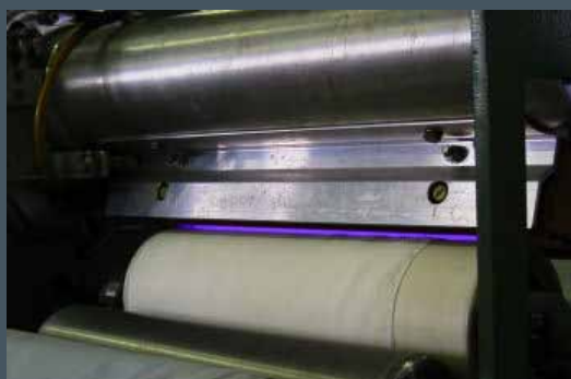
Corona behandeling (coatinglijn Centexbel)
