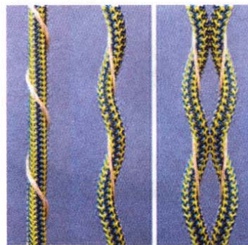
Deze toepassing illustreert het auxetisch effect: rond een touw van auxetisch materiaal is een gewoon wit touw gewikkeld. Wanneer een trekkracht op het auxetisch touw wordt uitgeoefend gaat dit uitzetten en daardoor opkrommen rond het gewone touw. (foto's: TWA netwerk)
